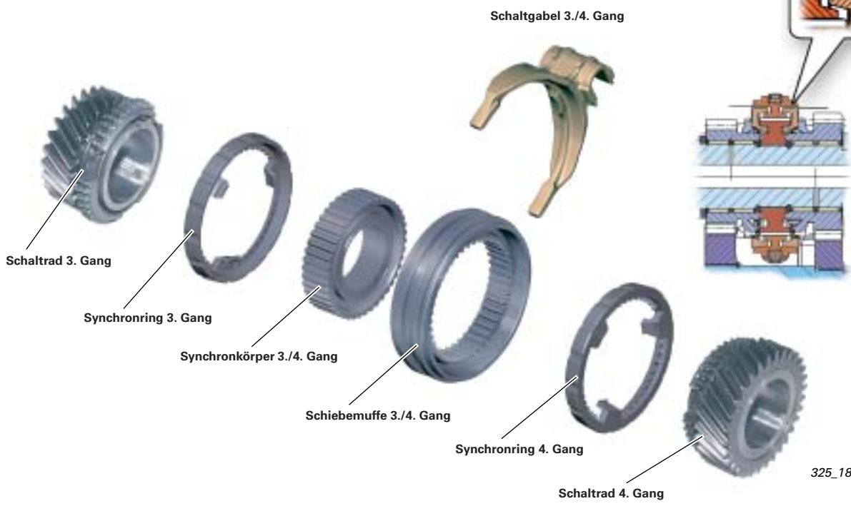
Einfach-Außenkonussynchronisation 3./4./5./6. und R-Gang
